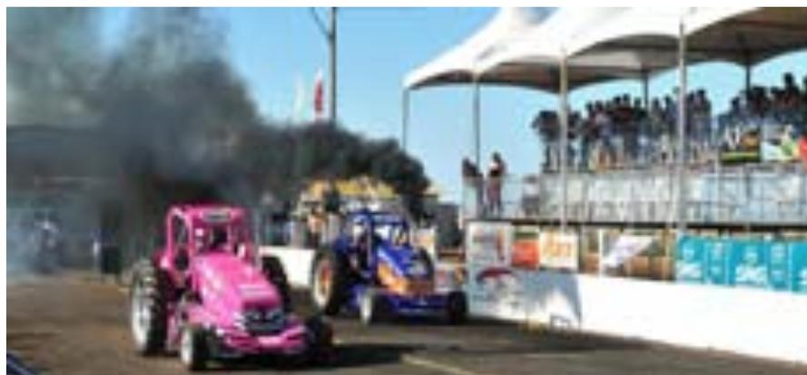
**LA “ARRANCADA”, es una competencia de carrera de tractores; se caracteriza por el equipamiento y adecuación de tractores agrícolas para una picada en una pista especialmente preparada de 1.200mts, llegando a una velocidad superior a 100km/h.**
