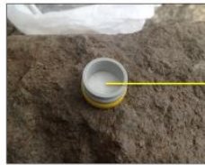
Figura n° 4: Fotografía de un tubo pasivo de NH 3 sin la malla de acero inoxidable.
